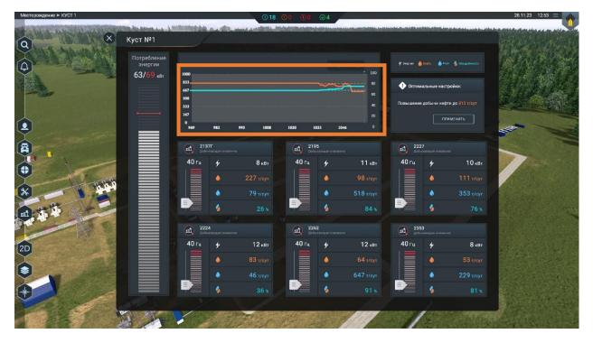
Ниже расположены регуляторы частоты вращения насосов, которые можно регулировать пальцем.
